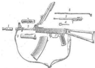
Рис. 54. Основные части и механизмы АКС-74У
