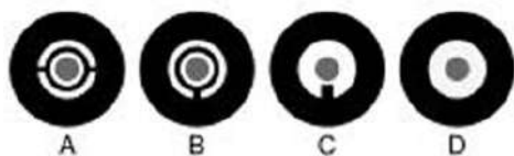
Рис. 109. Различные мушки, применяемые в диоптрических прицелах
