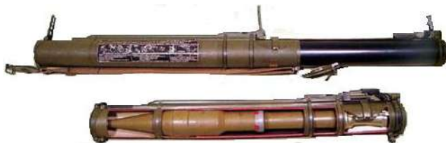
Рис. 91. Общий вид и характеристики РПГ-18: сверху – в боевом положении; снизу – в походном положении
