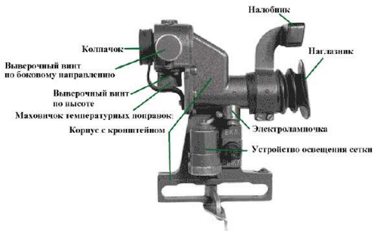
Рис. 114. Устройство прицела ПГО-7
