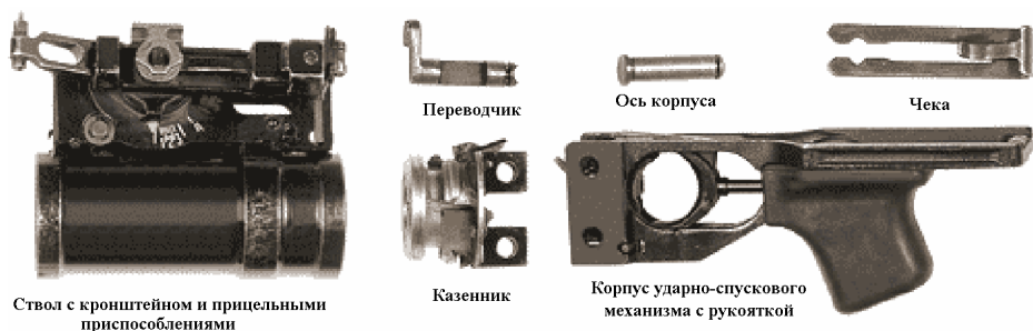
Рис. 83. Общее устройство подствольного гранатомета ГП-25
