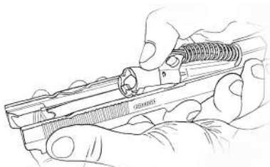
Рис. 37. Введение передней части ствола и передней части возвратной пружины в соответствующие полости затвора
