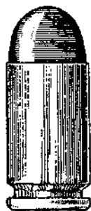
Рис. 27. Общий вид 9 мм пистолетного патрона и его устройство
