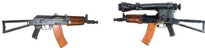
Рис. 53. Общий вид 5,45 мм автомата Калашникова укороченного: с откинутым прикладом (слева); с ночным прицелом (АКС-74УН2) (справа)
