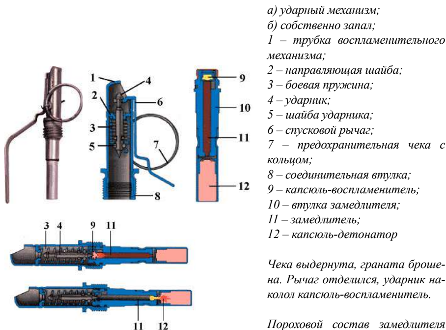
Рис. 99. Общий вид и устройство взрывателя УЗРГМ и его действие
