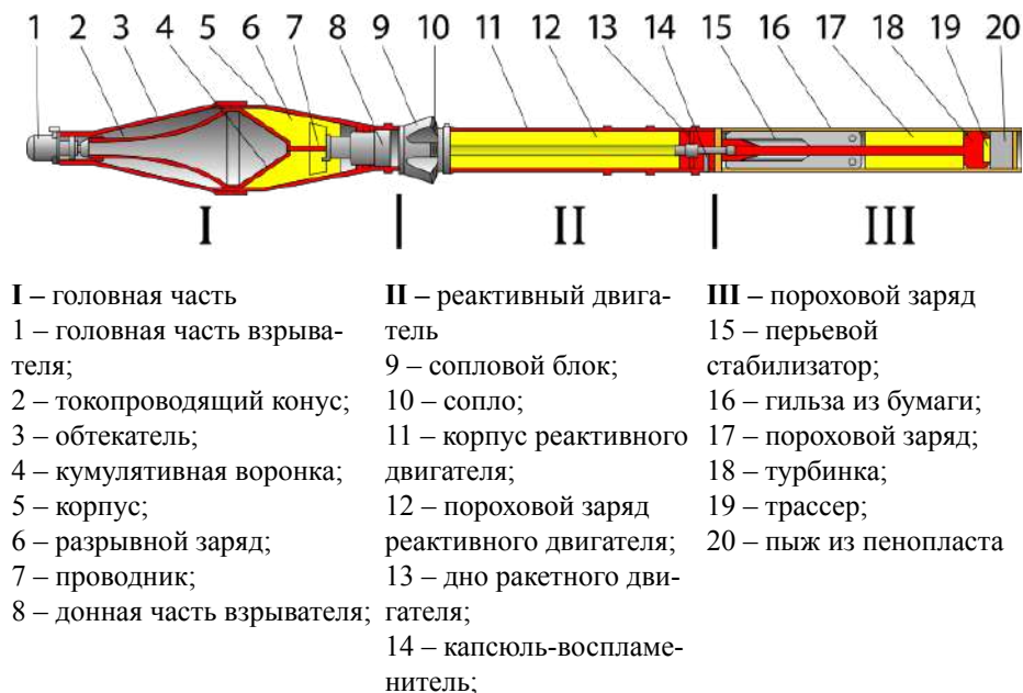
Рис. 75. Устройство выстрела ПГ-7В
