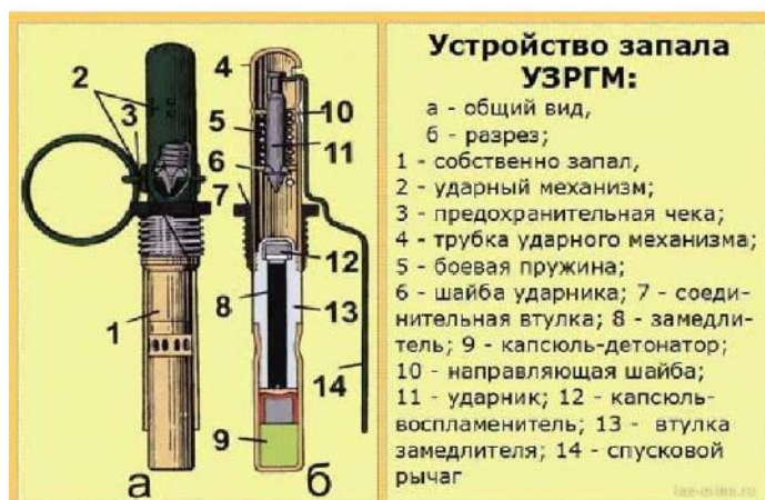
Рис. 74. Устройство зазала УЗРГМ
