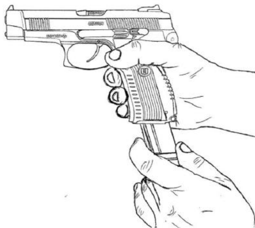
Рис. 49. Извлечение магазина из основания рукоятки
