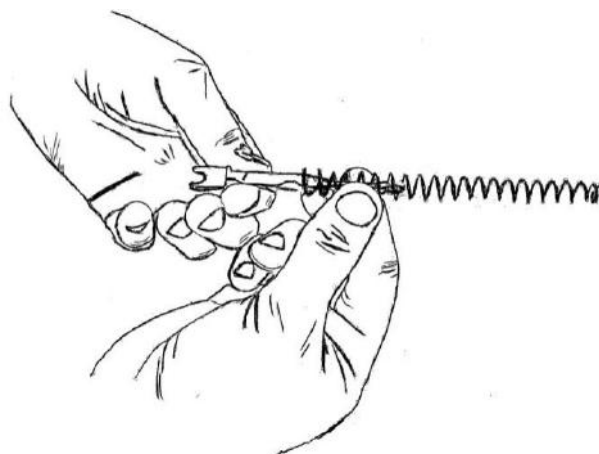
Рис. 53. Отделение возвратной пружины от штока
