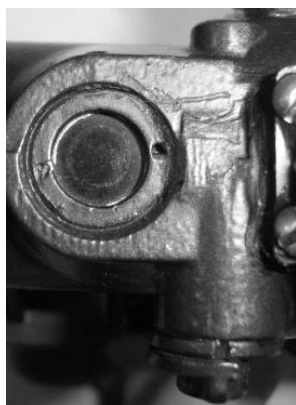
Рис. 106. Окно для зарядки люминесцентного экрана
