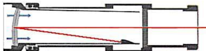
Рис. 91. Схема действия коллиматорного прицела
