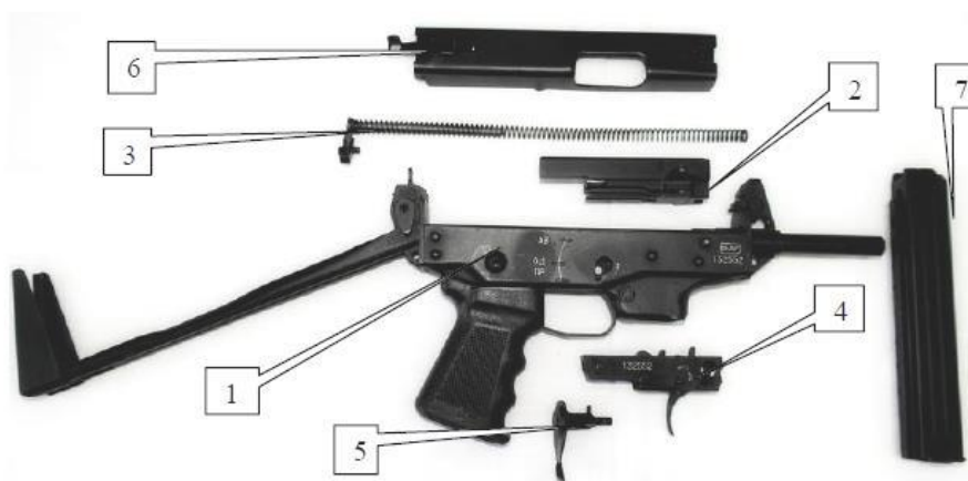
Рис. 68. Основные части и механизмы ПП-91 «Кедр»
