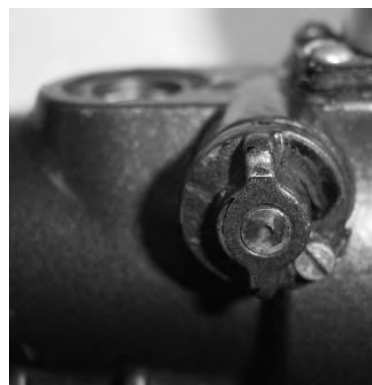
Рис. 107. Флажок переключения люминесцентного экрана
