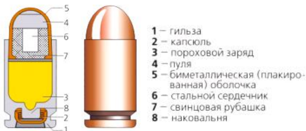
Рис. 45. Общий вид и устройство 9-мм пистолетного патрона
