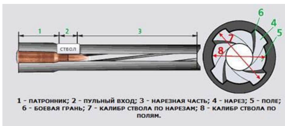
Рис. 15. Сечение канала ствола автомата
