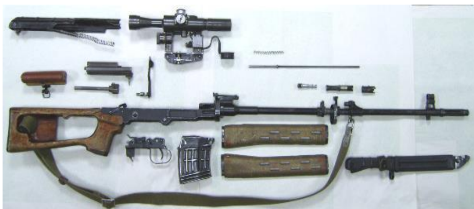
Рис. 58. Основные части снайперской винтовки Драгунова
