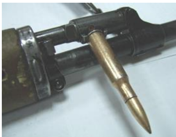
Рис. 61. Перестановка газового регулятора
