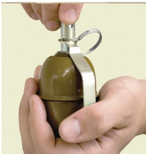
Рис. 82. Ввинчивание запала гранаты
